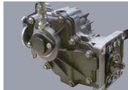
Hemos instalado un amortiguador par aliviar el impacto al detener la máquina.
